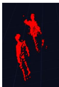
<図 1：LiDAR で観測した人の点群データ> <図 2：LiDAR で観測した空間の点群データ>
