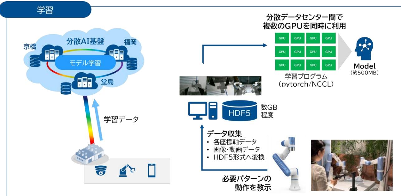
また、IOWN APN 経由で、福岡拠点のデータセンターに配置した学習済みモデルを用いた推論処理を稼働させ、約 600km 離れた大阪京橋に設置した自律型協働ロボティクスの推論動作を実行できることを確認しました。本実証では、以下の 3 環境で比較検証を行いました。
